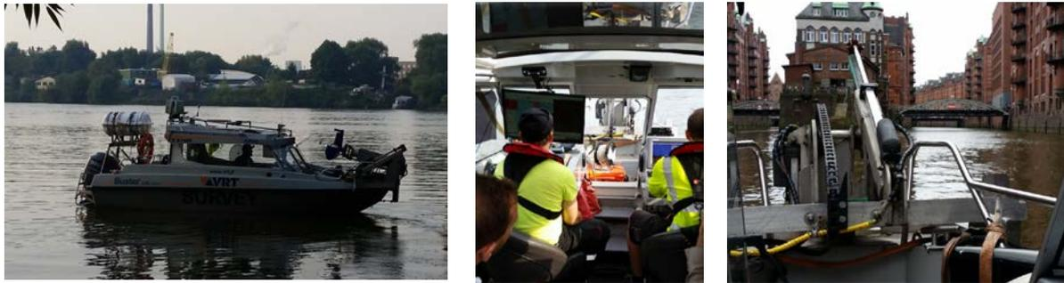
Untersuchungsboot mit Multibeam und Laser Scan, Besatzung, Klappmechanik
