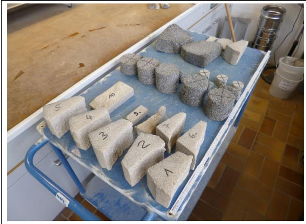
**Bild 5** Probekörper aus Bruchstücken
