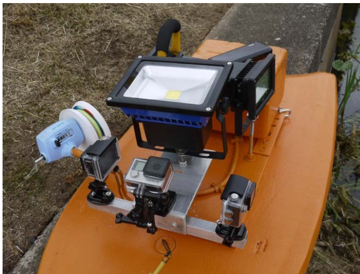
Abb. 20: Detail Beleuchtung, Aufnahmetechnik und Messeinrichtung
