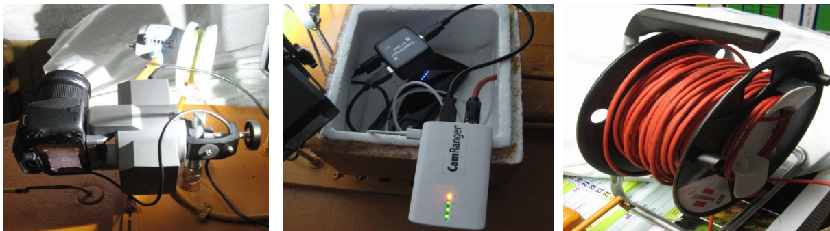
Abb. 23: Komponenten des CamRanger-Systems
