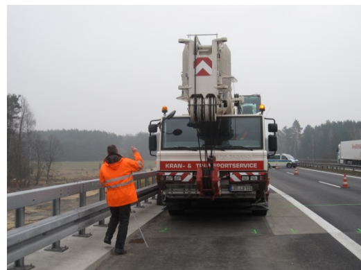
Bild 3: Belastungsfahrzeug - 48 t - Kran
