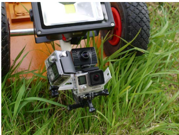
Abb. 19: Detail Aufnahmetechnik am Geräteträger Radachse
